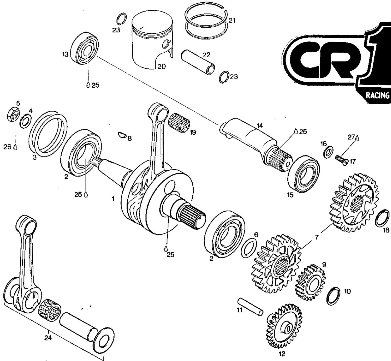
KURBELWELLE, AUSGLEICHSTRIEB, KOLBEN
